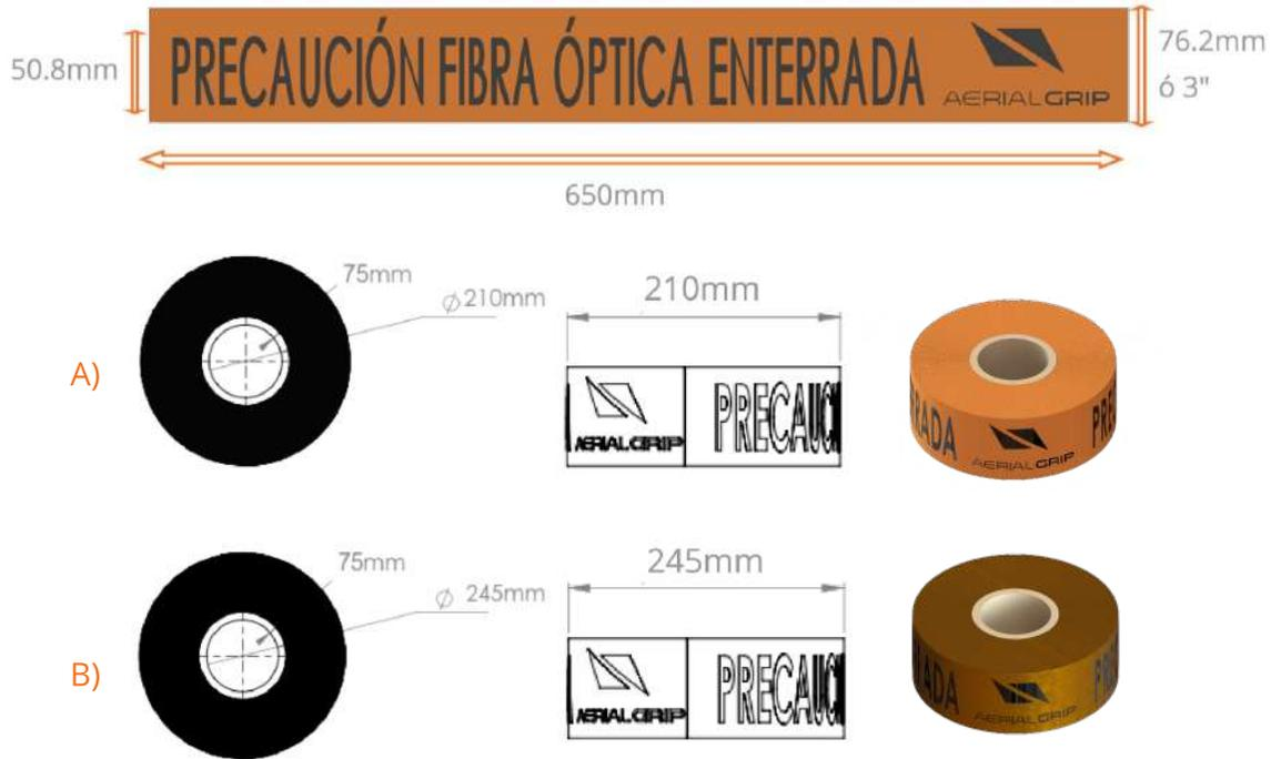
Figura1 Dimensiones de impresión y presentación de rollo individual
