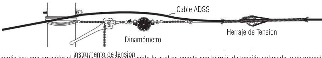
Después hay que proceder al final de la sección del cable la cual no cuenta con herraje de tensión colocado, y se procede a instalar un herraje de tensión temporal con una distancia de entre 3 y 4 metros alejado del poste.
