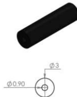
Fig. 5 Vista Isometrica cilindro negro de adaptación
