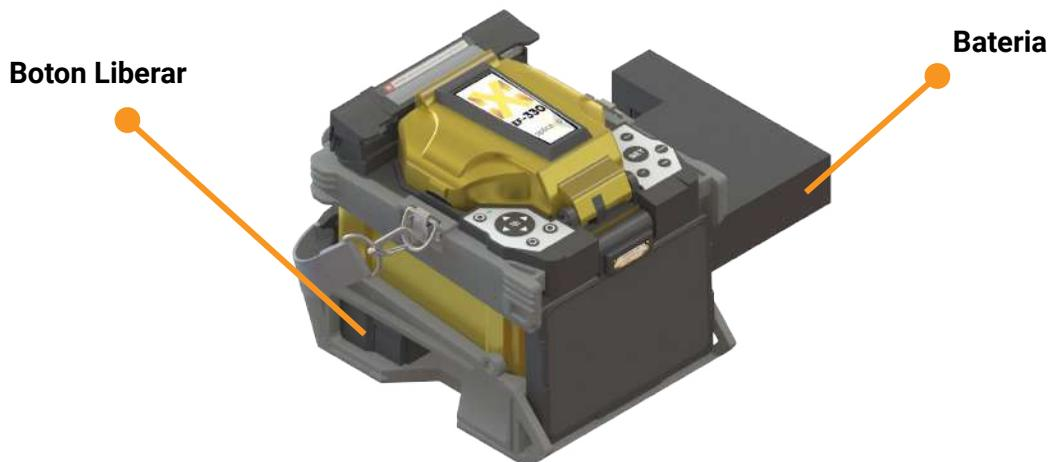
Inserte la batería en la base de la unidad de alimentación hasta que encaje en su sitio.
