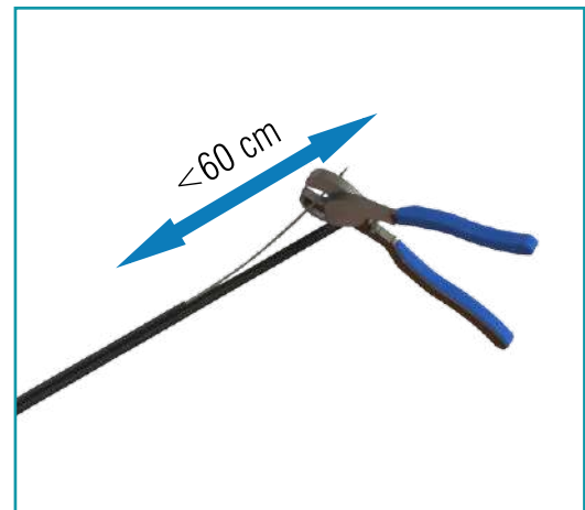
Imagen 10: Corte para colocar un preformado
