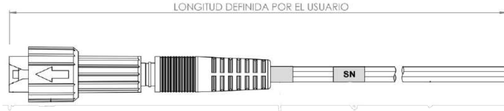
Fig 5. Dimensiones Pigtail con conector compatible con Huawei
