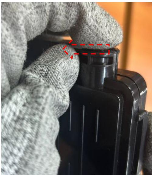
7. Con la mano izquierda baje el seguro utilizando el pulgar y empuje con su dedo índice sobre el orificio lateral.
