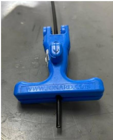
10. Proceda a realizar el desforre de aprox. 25 cm de cable utilizando una desforradora apta para cable flat drop.
