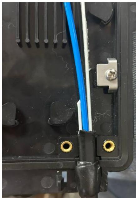
16. Posicione el cable en el canal del cierre de manera que la cinta quede al ras del borde.
