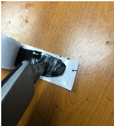
14. Con una cuchilla, proceda a cortar un trozo de cinta selladora.
