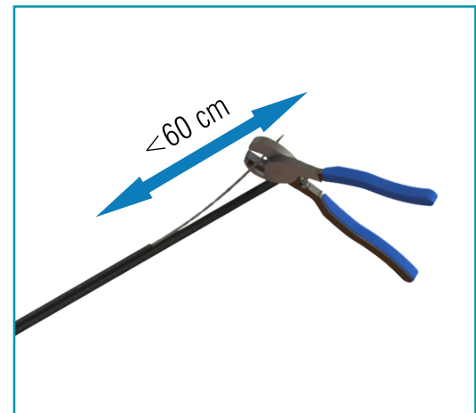
Imagen 10: Corte para colocar un preformado
