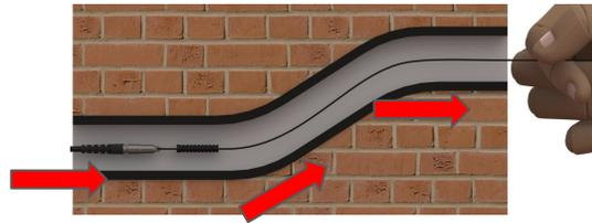
**Paso 12:** Tire del cuerpo principal del conector a través del tubo y alcance la posición deseada
