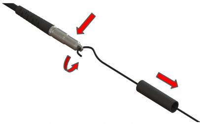
**Paso 9:** Inserte el cable de jalado en el anillo de sujeción del protector\*
