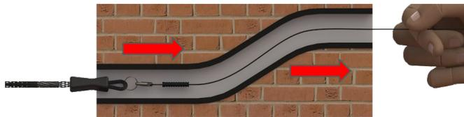
**Paso 17:** En este momento, la malla de jalado se puede utilizar para aplicar fuerza de tracción y pasar el cable por paredes o ductos
