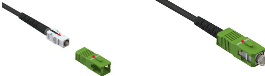
**Paso 3:** Ensamble el housing alineando las guías
