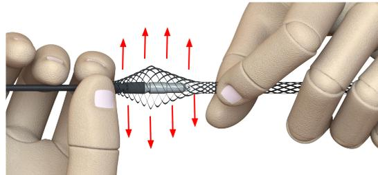
**Paso 14:** Conforme se empuja la malla de jalado, ésta se expandirá hacia afuera. El empuje se detiene cuando la mano derecha alcanza la punta del conector.
