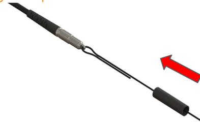
**Paso 10:** Coloque el anillo de engarzado sobre las cuerdas de alambre\*
