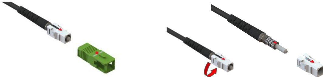
**Paso 5:** Retire el housing apoyando el tapón en una superficie plana y ejerza presión
