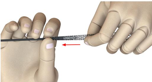
**Paso 13:** La mano izquierda aprieta la bota del conector y la mano derecha ingresa la malla en el cuerpo del conector.
