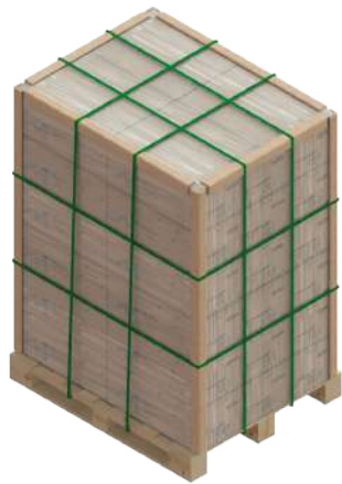
Fig. 4 Estibado de 36 cajas MEXFO03, 6 camas de 6 cajas
