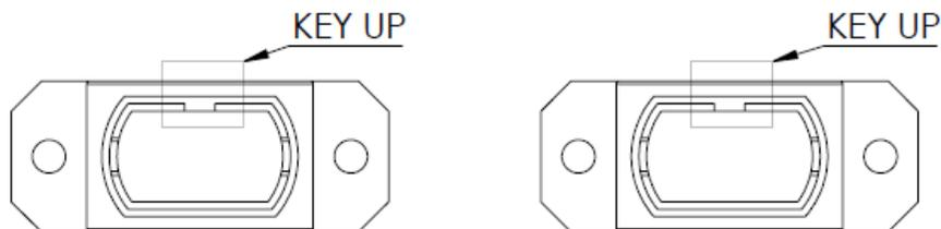
**Fig.2** Tipo de configuración en acoplador MTP®/MPO
