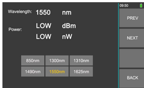
Medidor de potencia óptica
