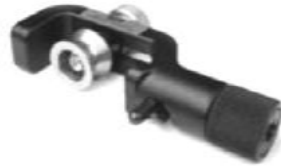
Cortadora transversal de armadura. Desforre de la cubierta corrugada de los cables armados.
